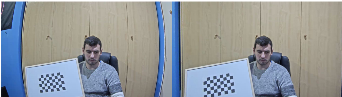
Figura 6: Exemple de correcció de la distorsió radial d'una imatge
