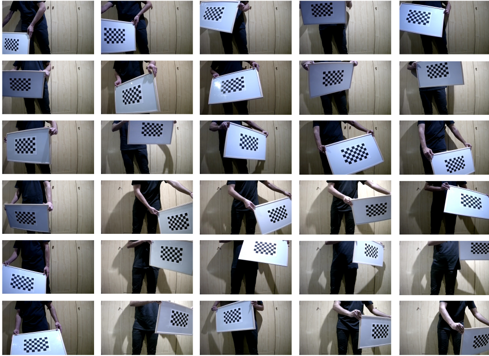
Figura 8: Imatges del procés de calibratge mitjançant un patró en forma de taulell d'escacs
